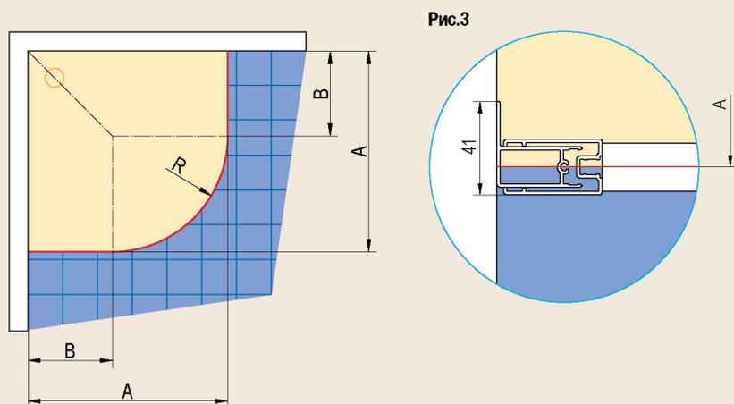
A - расстояние, измеренное от стены к средней линии горизонтального профиля рамы
