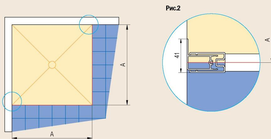
A - расстояние, измеренное от стены к средней линии горизонтального профиля рамы
